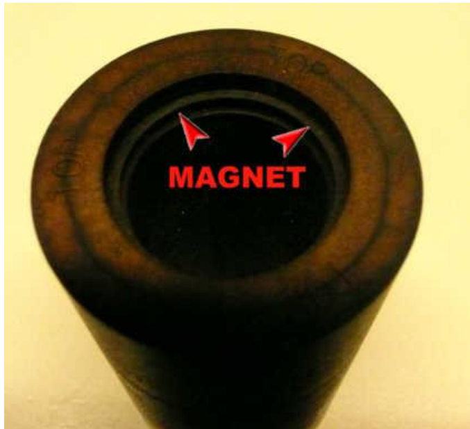
Abb. 2: Der Magnetring des Produktschwimmers
